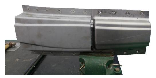
② 根据 E 板件长度尺寸,切割分离 B 板件(如下图)。
