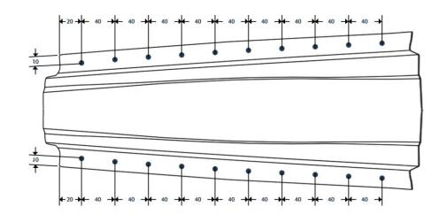
② A、B、C 板件定位,使用电阻点焊焊接在一起,每边 10 个焊点(如下图)。
