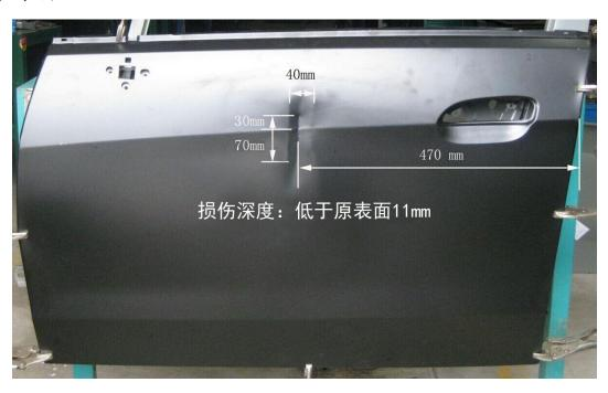
(注意:条形凹陷为纵向,凹陷损伤穿过车身线。损伤长度由两部分组成共 100mm,车身线上部为 30mm,车身线下部为 70mm;损伤宽度为 40mm;损伤深度为 11mm。)
